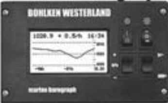
elektronischer Barograph mit NMEA Datenausgang und Windows Software. Ein und Dreistundentendenz akustischer Alarm bei starkem Druckabfall. Lieferbar in drei Displayfarben. Als Einbau oder Aufbaugerät.
