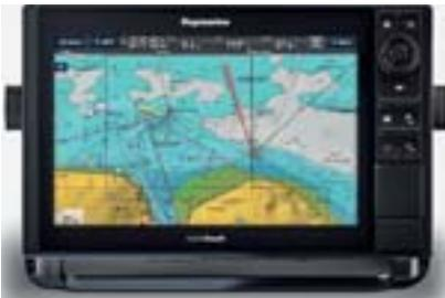
Mit der Layline-Funktion sehen Sie sofort den schnellsten und möglichst effektiven Weg zum Zielort, wobei die aktuellen Windverhältnisse und Strömungen (falls bekannt) einberechnet werden. Die dynamische Aktualisierung mit den ins System eingebundenen Instrumenten – es wird ein Speedlog, die Winddaten vom Windinstrument
